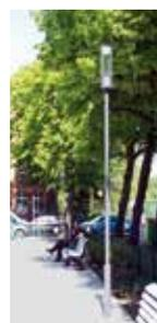
*Abb. links: RESIDENZA mit LED-Modul LEVO, Fa. Hess GmbH Licht + Form. Leistung ca. 33 W, 3000 Kelvin. Asymmetrische Lichtverteilung. RESIDENZA-Mast, Lichtpunkthöhe 4 m. Konzept Letteplatz: planung.freiraum. Foto/Copyright: Hess GmbH Licht + Form*
