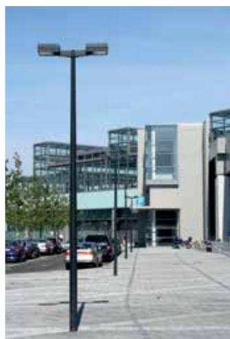
Abb.: BEGA-Kofferleuchten am Bahnhof Südkreuz (Aufstellung 2007). Halogen-Metallampfen, je 70 W, asymmetrische bandförmige Lichtstärkeverteilung. Lichtplanung Edgar und Ruth Schlaefle, Berlin. Copyright: BEGA Gantenbrink-Leuchten KG
