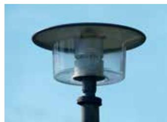
*Abb.: Rondero (auf Stahlmast), ab 2002. Natriumdampf-Hochdrucklampen HSE oder Halogen-Metall-dampf-Lampen HIT-CE, Lichtlenkung und Entblendung. Energieverbrauch und die CO<sub>2</sub>-Emissionen werden um mehr als die Hälfte gesenkt. Foto: Sabine Röck, Berlin*
