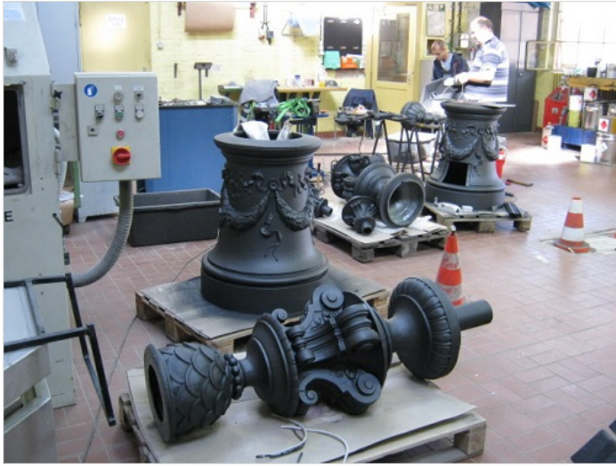
Restaurierung in Handarbeit, hier am Beispiel der Kandelaber und Masten der Semperoper in Dresden
