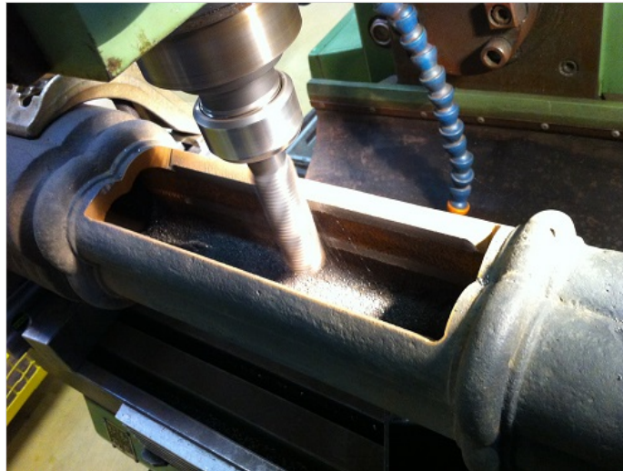
Fräsarbeiten am Mast für Revisionsklappe
