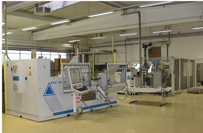
Hauseigene Leihfeld CNC-Drückmaschine
